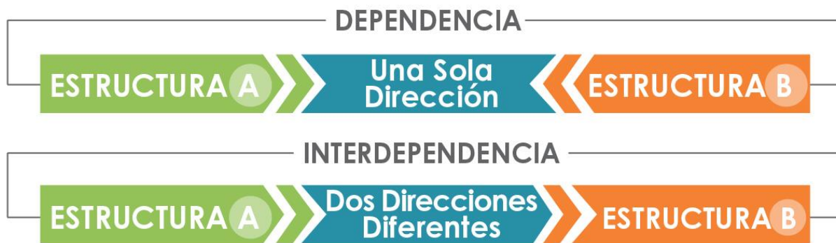
Figura 54. Ilustración de definiciones para dependencia e interdependencia. Fuente: Informe de Infraestructura e Interdependencia, Puerto Rico, 2018
